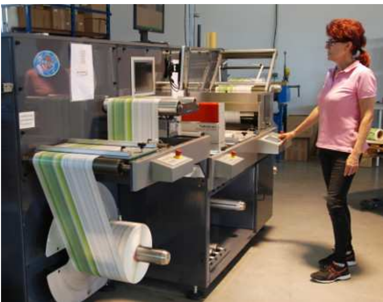
Foto 5: Zeitgleich mit der Druckmaschine wurde auch die Konfektioniermaschine vom Typ Sirius des französischen Herstellers Smag installiert.
