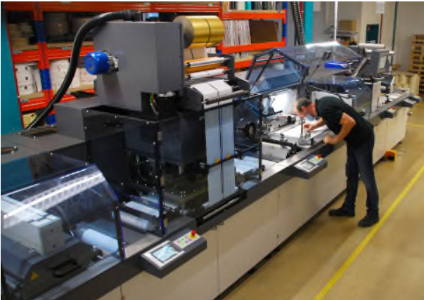
Abbildung 2: Die iconcept von Smag Graphique ist eine modulare Produktlinie zur Veredelung von vorbedruckten Etiketten.
