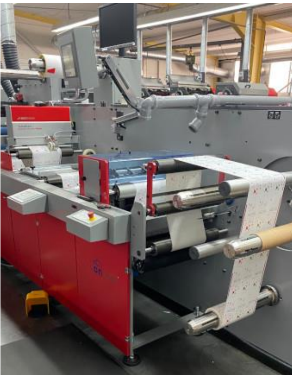
Foto 2: Die spezielle Wickeleinrichtung ermöglicht unterschiedliche Hülsenkerne und Wickelrichtungen auf jeder der drei Achsen.
